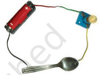
चित्र 3.15 — (ख) विद्युत चालन परीक्षण-यंत्र का उपयोग करके पदार्थ की पहचान
