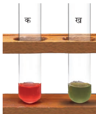
चित्र 2.8 — लाल गुलाब के अर्क में (क) नींबू का रस और (ख) साबुन का विलयन मिलाने पर रंग-परिवर्तन
